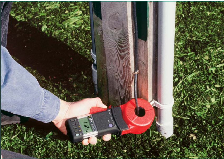
Modelo 3731 haciendo un test a una varilla de toma de tierra.
